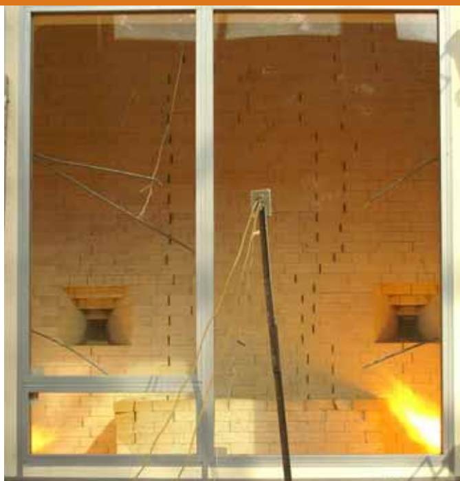
Огневые испытания противопожарной стеклянной перегородки Fireline EI60
